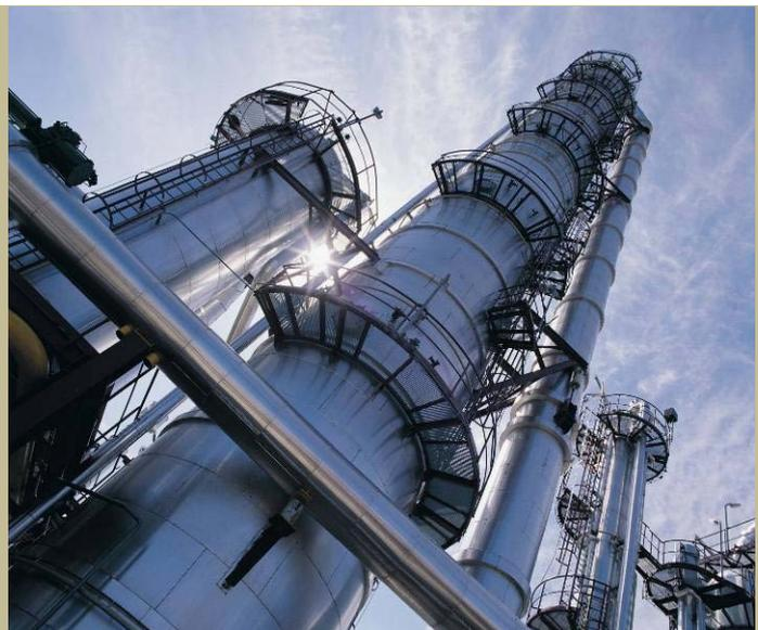
**Сварной металлический настил** изготовлен из чёрной стали S 235 JR обычно с оцинкованной поверхностью (но может быть и без покрытия). **Горячий цинк** защищает настилы от коррозии.
