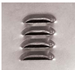
деталь – вентиляционное отверстие „жалюзи“
